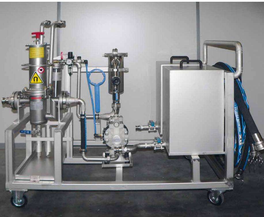
Abscheidung kleinster, magnetischer Rückstände und Filtrierung von wässrigen Reinigungsmedien.
